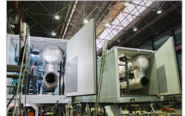
Пакетирование СУТ для модульной ГПЭС 3,35 МВт
