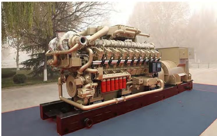
Линейка газовых двигателей используемых АО «РусАтом-ЭлектроТехМаш» в производстве ГПЭС включает в себя установки мощностью от 250 до 9000 кВт.
